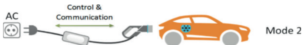
Figura 26 Modo de Carga 2 (EV Charging Modes | Deltrix Chargers, n.d.).
