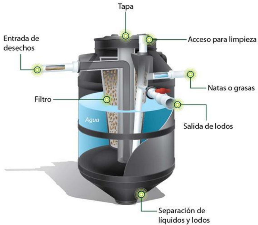
Ilustración LXVI Partes de biodigestor de www.rotoplas.com
